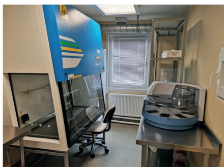
Ламинарный шкаф II класса защиты и станция для выделения нуклеиновых кислот
