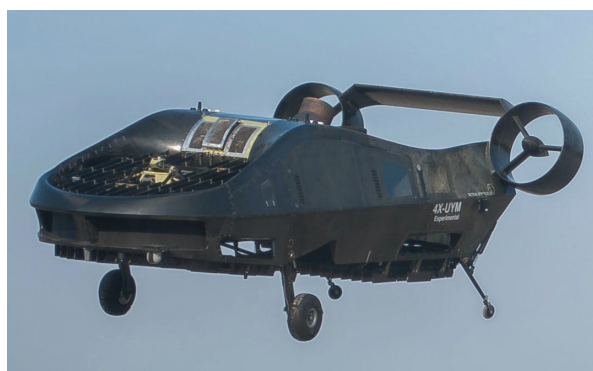
Рис. 1. БПЛА «Корморант» или «воздушный мул» (Израиль) [ https://scioinfotech.com/cormorant-israel-vtol/ ].
