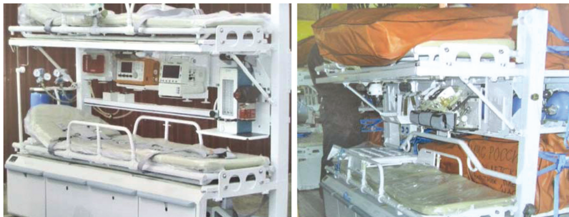
Рис. 2. Модуль медицинский самолетный (слева) и вертолетный (справа).
