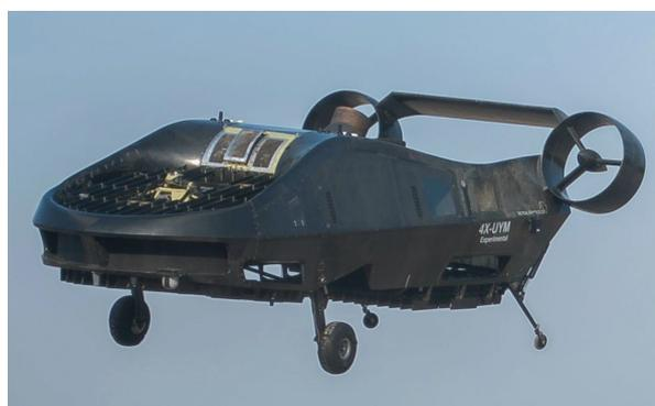
**Рис. 1.** БПЛА «Корморант» или «воздушный мул» (Израиль)
